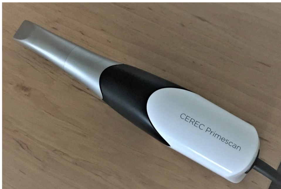
1. ábra A CEREC PrimeScan kifejlesztése során azt a megoldást helyezték előtérbe, hogy már a felvétel alatt a kézidarabban „előkészítik” az adatokat. A gyártó ezzel indokolja a szkennervej súlyának és méretének növekedését
